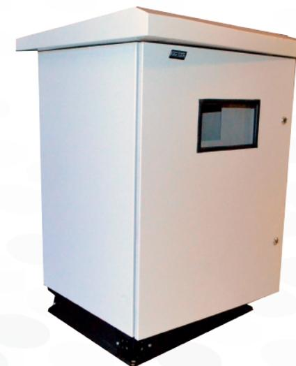
Gabinete construido tipo monobloc, con chapa de acero AWG 14 (2,1 mm), retenedores de puerta, puerta abisagrada, cierres especiales tipo triangular y/o pomona, placa de montaje zincada, zócalos a elección de 100 y 200 mm de altura, también tipo trineo. Pintura color Ral 7035, espesor de la pintura mayor a 80 micrones (IP65). Tejadillo ventilado con filtro antipolvo. Incorporación de cáncamo de izaje y porta plano metálico interno.
